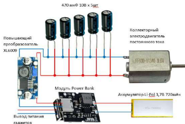
Рисунок 2 – Схема подключений электронных компонентов электрогенератора
